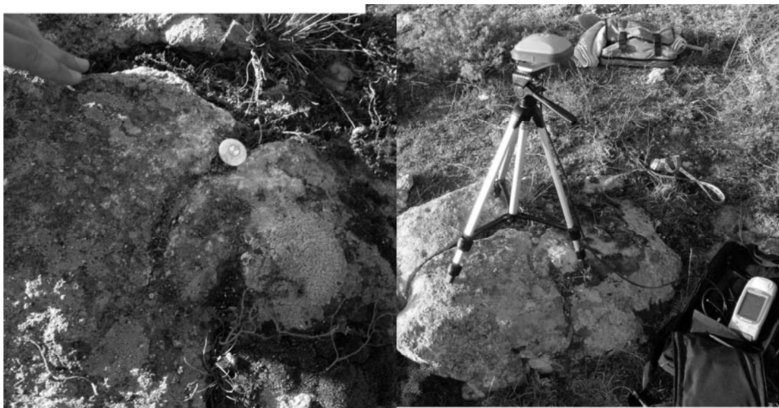
Фиг. 7. Поставяне на стоманен пирон и измерване на координатите на реперен пункт С
